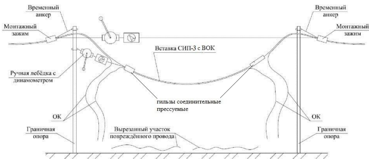
Рис. 20. Устройство вставки вместо поврежденного участка провода СИП-3/ВОК
