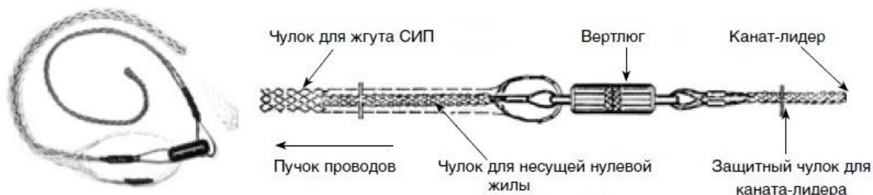
Рисунок 8 – Узел соединения провода СИП-2/О с тросом-лидером.
