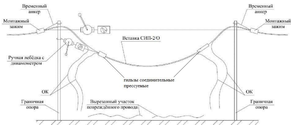
Рис. 16. Устройство вставки вместо поврежденного участка провода СИП-2/О
