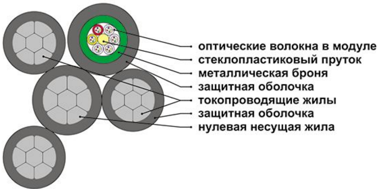
Рис. 1- Конструктивное исполнение кабеля СИП-2/О.
