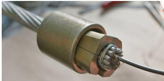
Рис.6. Установка кулачков во втулку конусную.
